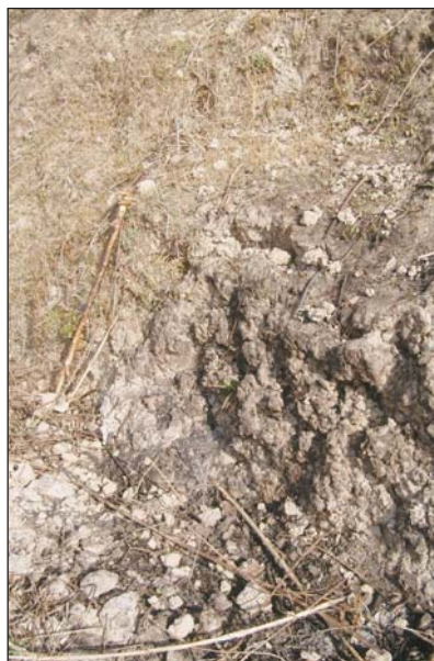
Растрескивание рыхлого грунта вблизи уступов полей-террас с образованием комковатой структуры.
